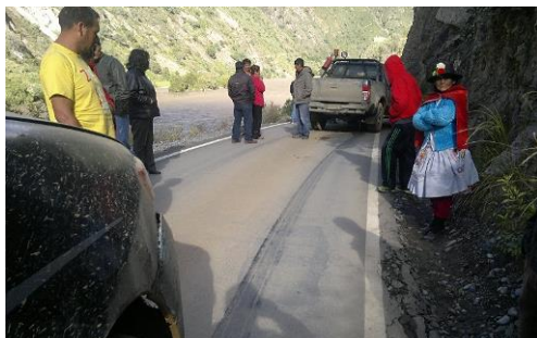
Se observa la huella de 18.4 metros arrastrado de frenado de camioneta loco.
